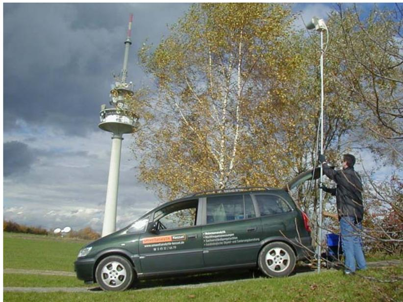
**Abb. 4-4:** Messung der Radarstrahlung des Flugsicherungs- und Luftraumüberwachungsradars aus Hohenlinden-Birkach. Die Messung wurde exakt in Höhe der Schlafräume des benachbarten Hofes durchgeführt (Obernhof 2 in Schnaitsee).
