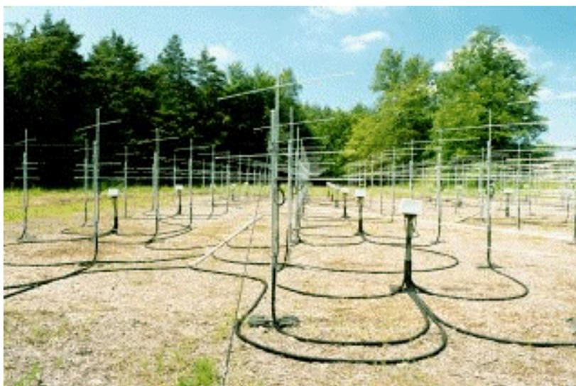
Bild 2-13: OSWIN (Ostsee-Wind-Radar) in Kühlungsborn; ein VHF-Radar, bestehend aus 144 Einzelantennen (4-Elemente-Yagi) zur Untersuchung der Dynamik und Struktur der Tropo-, Strato- und Mesosphäre (Quelle: [6])
