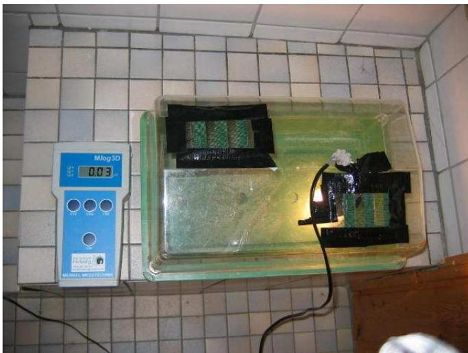
Gerät zur Messung des magnetischen Feldes
